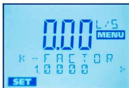
Définissez le **Facteur K** pour garantir une conversion correcte de la **fréquence** du capteur de débit en un **débit**. Le **Facteur K** est fonction de : **Modèle de capteur et Diamètre interne réel** (taille des tuyaux, matériau des tuyaux, norme des tuyaux). Se référer au **Manuel d'utilisation du capteur** pour obtenir la valeur correcte. **Plage du Facteur K : 000.01 à 99999** (le facteur K ne peut pas être défini à 0)
